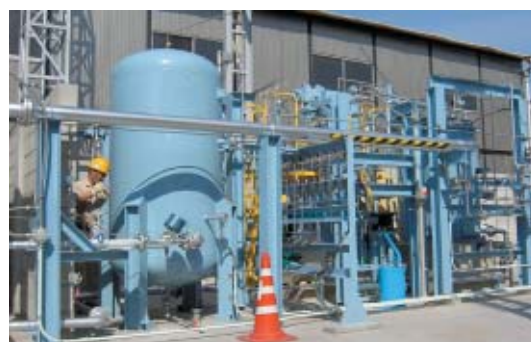
NEDOの委託研究で製作した 高圧水素圧縮機
