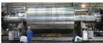
発電用一体型ロータシャフト
