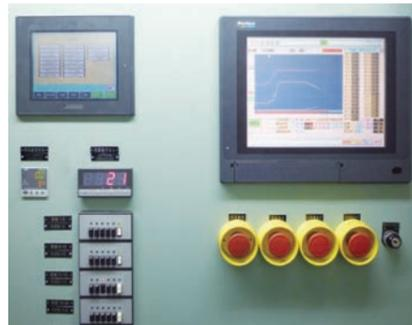
コントローラはMHPC-V機で好評をいただいている「VISTAC-II」を搭載。設備が非常に大きいことにより、プレス本体とローダー/アンローダーとのインターロックに赤外線通信を利用して無線化、また、ローダー/アンローダーへの電源線供給方法の見直しなどメンテナンス性も考慮しつつ、更に使いやすいように操作性を向上させています。
