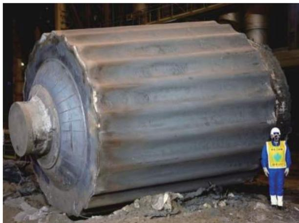
写真1 試作した670トン鋼塊の外観
