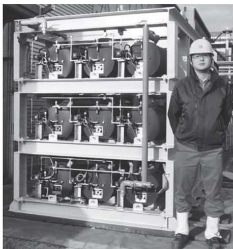
写真 1 1,000Nm<sup>3</sup> 級大型 MH タンクシステムの外観
