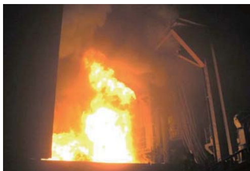
写真4 IPB 試験使用時の火炎状況
