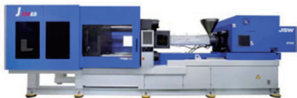
図 1 J-ADS 中型射出成形機 (J350ADS-890H) の外観
