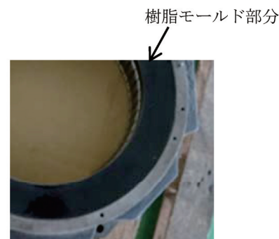
図6 負荷性能の向上のための樹脂モールド
