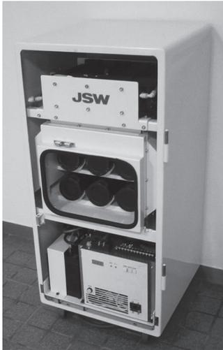
図 25 非常用燃料電池電源の外観写真
