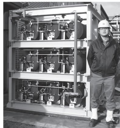
図17 水素100 kgを貯蔵可能なタンクシステムの外観
