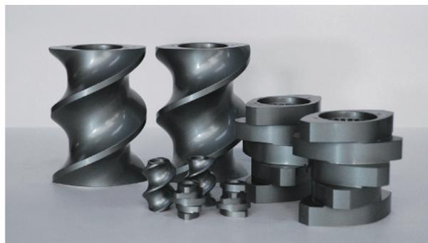
写真1 新開発したLSP-Qのスクリュ外観
