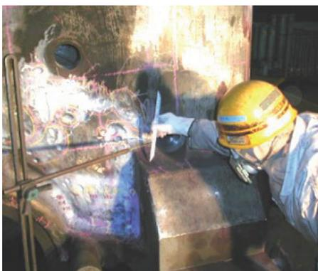
図6 従来の寸法測定作業
