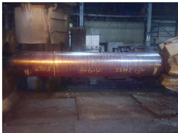
図 17 上下 R 形状金敷により仕上げを行った丸棒の外観
