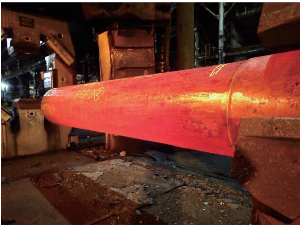
図20 仕上り後の試験材 (打上径 \phi 650_{-0}^{+15} )
