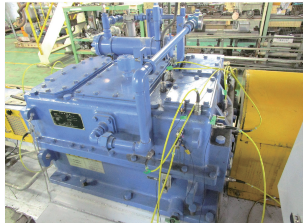
図9 減速機に装着した加速度センサ
