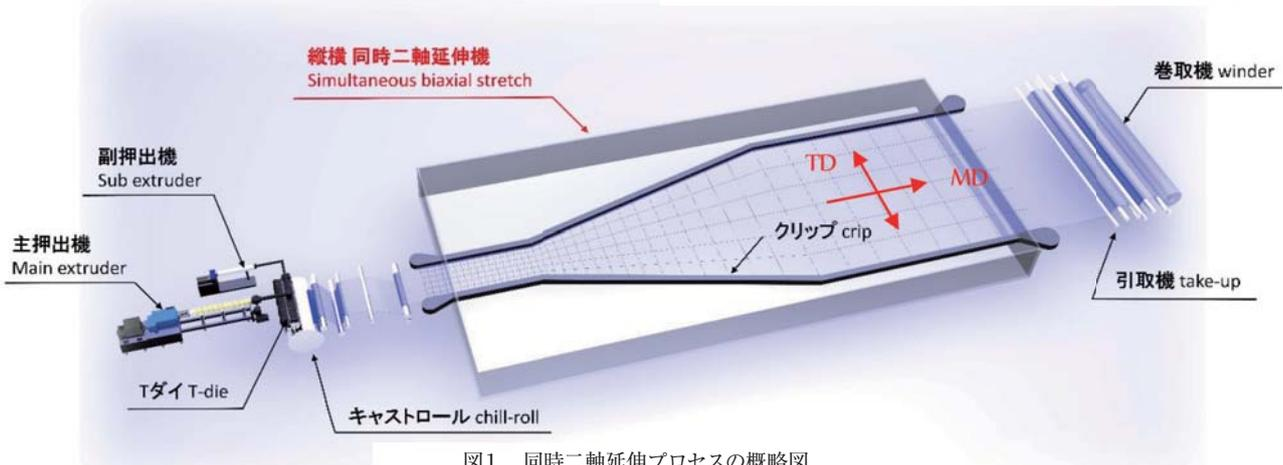
図1 同時二軸延伸プロセスの概略図
