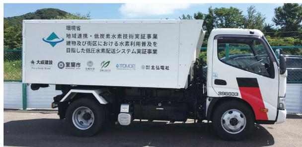
図4 水素ガス配送用トラックの外観写真 (コンテナ内部にMHタンクが搭載)
