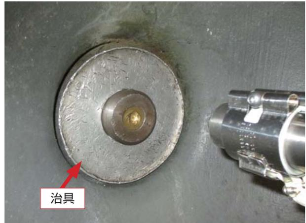
図2 ノズル先端を塞ぐ治具
