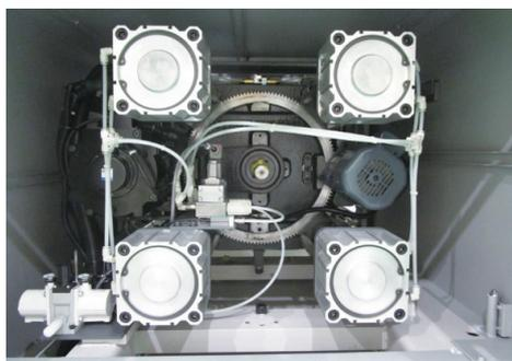
写真4 型締精度維持装置
