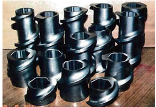
図3 六角軸を採用したセグメントスクリュピース (第五世代TEXまで採用)
