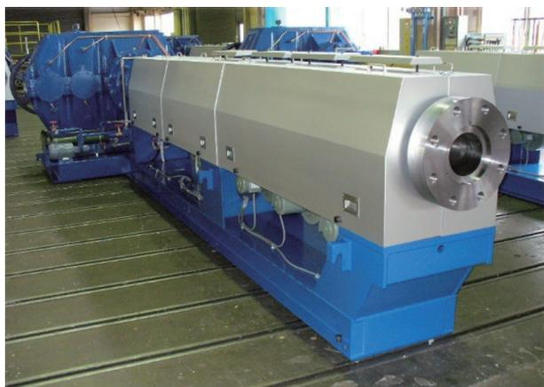
写真1 紡糸用単軸押出機
