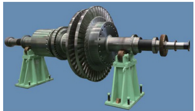
図6 A-USC 回転試験用タービンロータ (溶接一体化後) のブレード取付時外観写真
