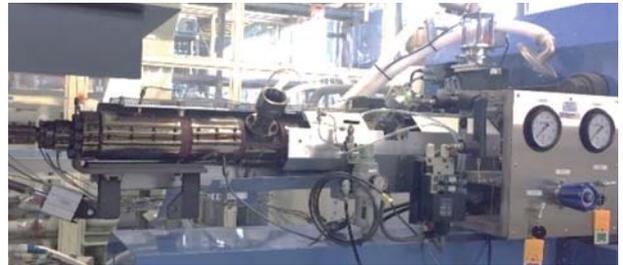
図2 J180AD-180Hの低圧発泡射出装置
