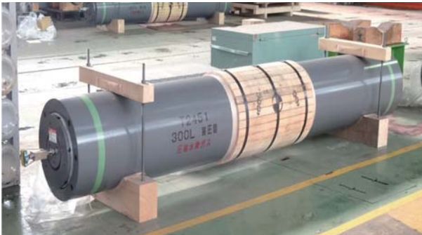
写真2 鋼製蓄圧器外観
