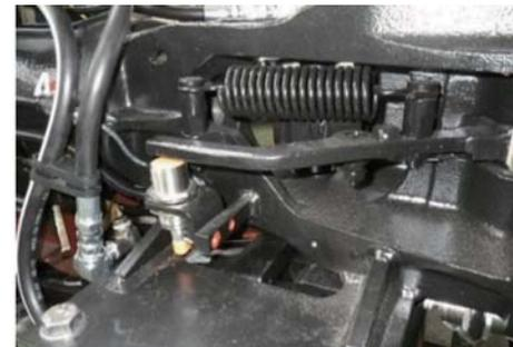
写真2 近接センサー取付部（連結面位置検出）
