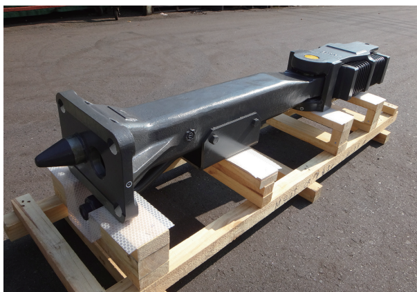
写真1 採用球面軸受形連結器及び緩衝器
