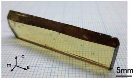
図9 2インチ長 SCAAT™ シード上に成長させた *m* 面 LPAAT GaN 単結晶
