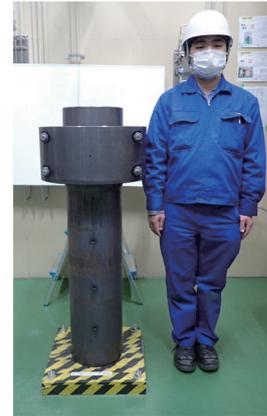
図12 4インチシード対応オートクレーブの外観写真
