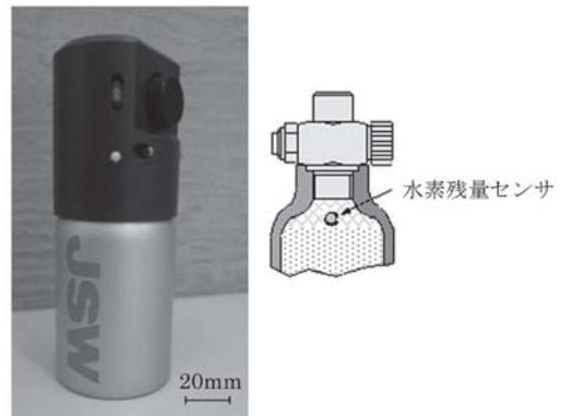
図18 MH キャニスター内の残量センサ導入位置
