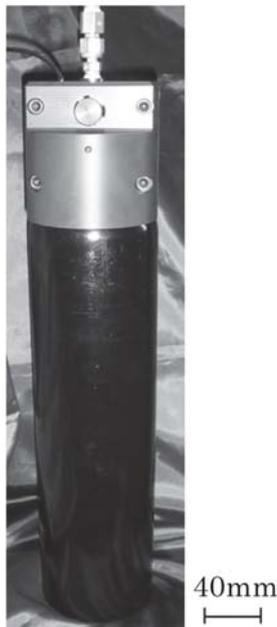
図21 MHCh-800L 残量センサ取付時の外観
