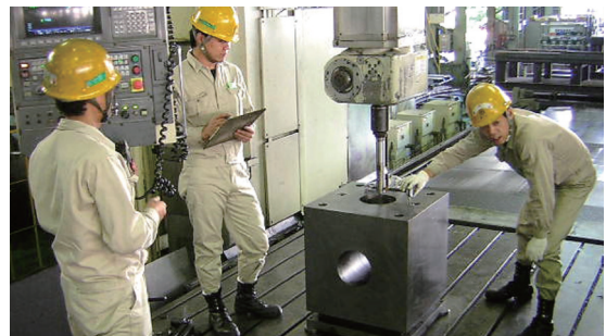
写真4 加工機械の精度検査 (設備保全)
