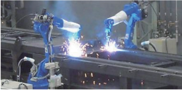
写真2 溶接ロボットによる自動溶接
