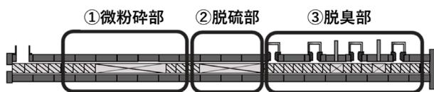
図1 脱硫スクリュの基本構成
