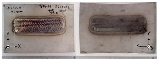
(a) 溶接部表面 (b) 溶接部裏面
