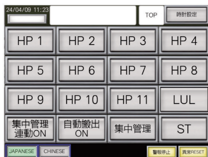
図 4 遠隔操作する装置選択画面
