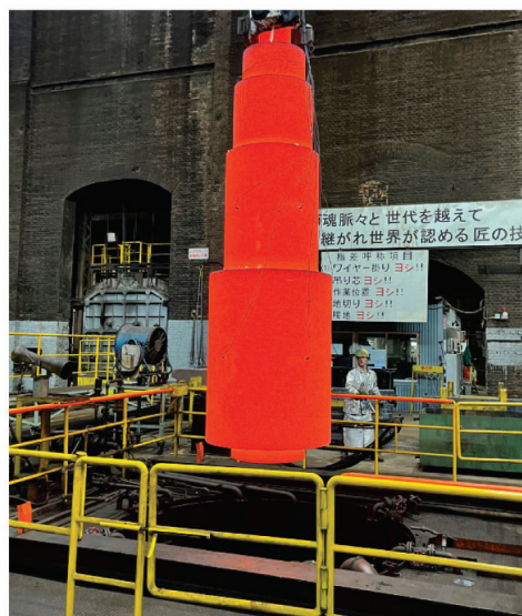
図13 高 Cr 試験ロータ
