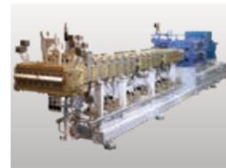
プラスチック二軸混練押出機 (TEX)
