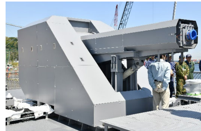
試験艦あすかに搭載された試作レールガン (写真：自衛艦隊HPより引用)
