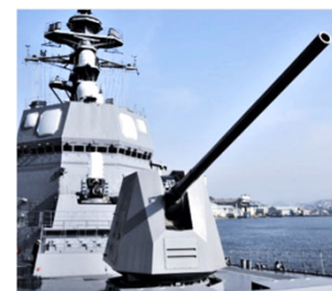
62口径5インチ砲 (写真：海上自衛隊提供)
