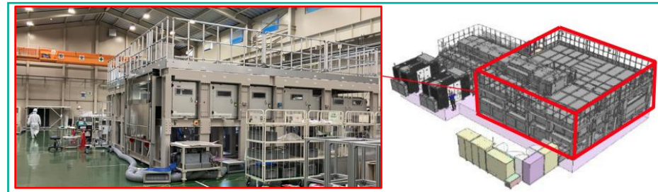
G8 OLEDパネル向け F-ELA装置
