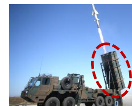
各種ミサイル発射筒 (写真は12式地对艦誘導弾発射機) (写真：陸上自衛隊HPより引用)
