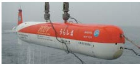
閉鎖式燃料電池搭載
