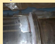
折損部反対側の表面割れ状況
