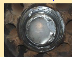
軸破断面状況
